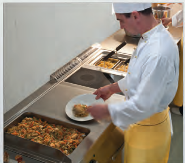
22-Liter-Becken aus 304 AISI Edelstahl mit 15 mm Verbundbodenplatte (12 mm Unterschicht aus Weichstahl in Verbindung mit einer 3 mm starken Deckschicht aus korrosionsbeständigem 316 AISI Edelstahl) garantiert gleichmäßiges Kochen
