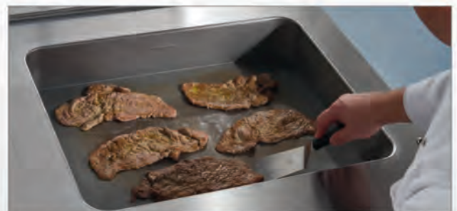
22-Liter-Becken aus 304 AISI Edelstahl mit 15 mm Verbundbodenplatte (12 mm Unterschicht aus Weichstahl in Verbindung mit einer 3 mm starken Deckschicht aus korrosionsbeständigem 316 AISI Edelstahl) garantiert gleichmäßiges Kochen
