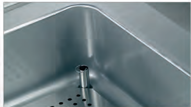
22-Liter-Becken aus CNS DIN 1.4301 mit 15 mm Verbundbodenplatte (12 mm Unterschicht aus Weichstahl in Verbindung mit einer 3 mm starken Deckschicht aus korrosionsbeständigem 316 AISI Edelstahl)
